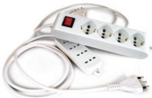
L'uso di ciabatte è consentito solo in luogo asciutto, ben riparato e per la ricarica di apparecchi a batteria. Esse non potranno essere impiegate nelle aree di lavoro soprattutto a causa della possibile presenza di infiltrazioni d'acqua, pozzanghere, spruzzi e in quanto l'azione meccanica dovuta alla possibile caduta di materiali comporta un facile rottura di questi dispositivi
